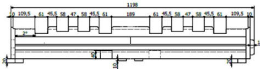
Coupe longitudinale Rectosten Coffrant sans languette
