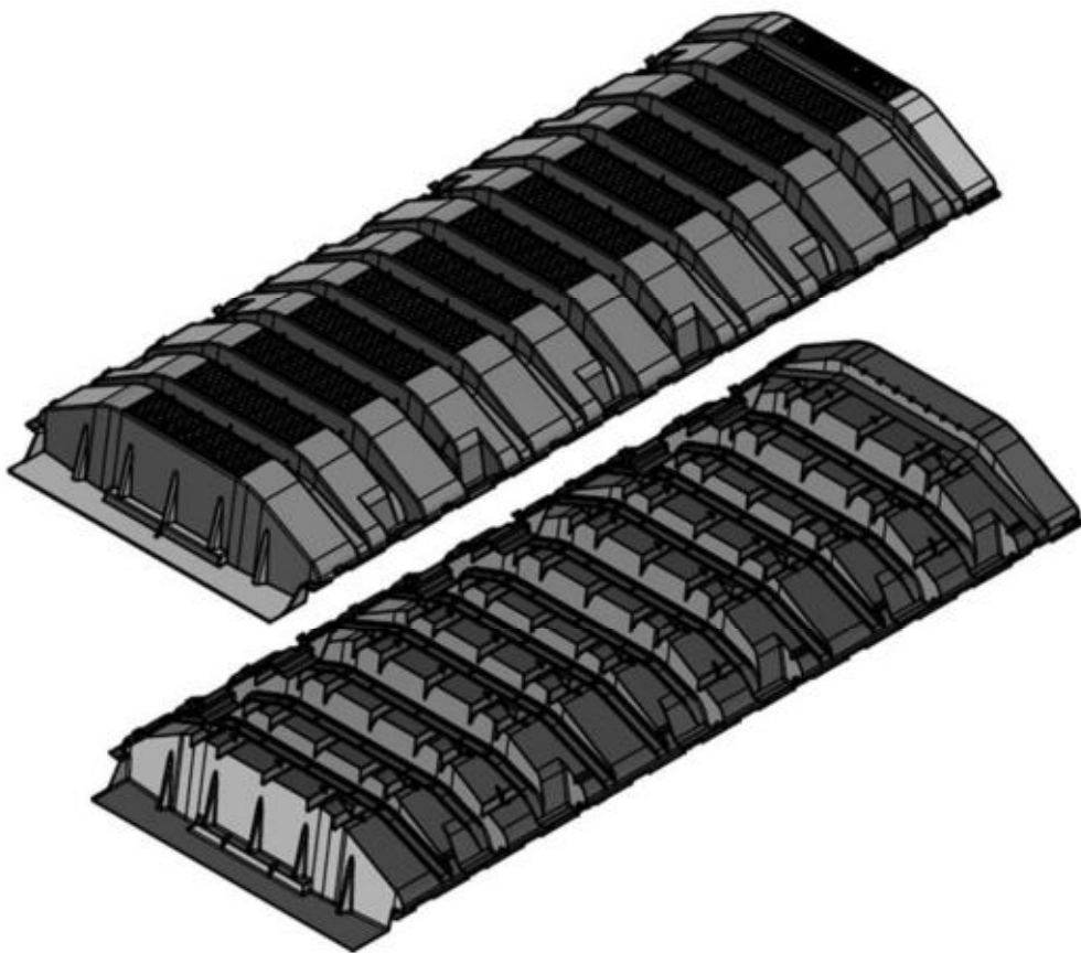
Vues en 3D du RectoplastVS (haut : vue du dessus de l'entrevous ; bas : vue du dessous de l'entrevous)
