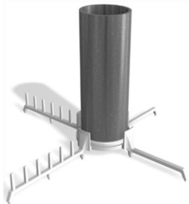
Fig. 10.9 : Schémas des cales de maintien des tubes de levage en phase provisoire
