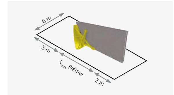
Implantation de façon à ce que le Prémur soit parallèle à l'axe de levage de la grue. Sol avec surface plane, pente mesurée en tous sens de 5% maximum et portance du sol suffisante : classe PF2 minimum.
