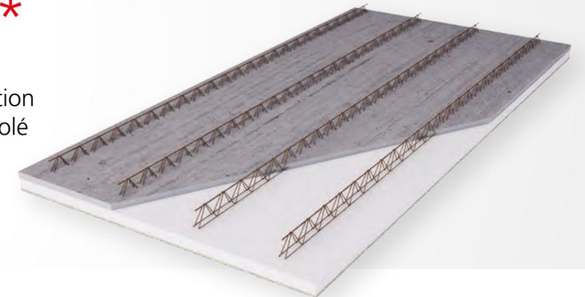
Prédalle BA proposée avec ou sans étai, elle est équipée d'un isolant en sous-face fixé en usine et pouvant aller jusqu'à 15 cm d'épaisseur. Elle comporte un appui en béton de 5 cm.
