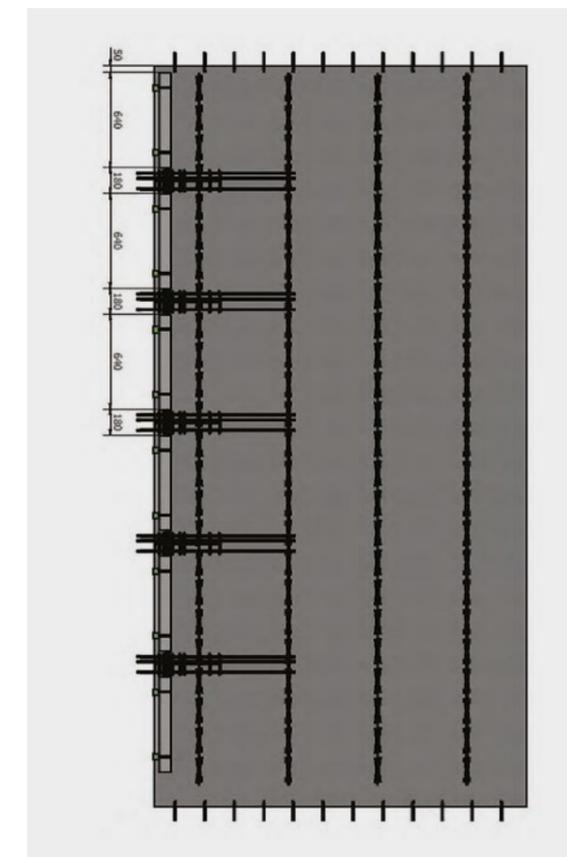
■ Rive de ThermoPrédalle® BA 0,45 munie de rupteur thermique.
