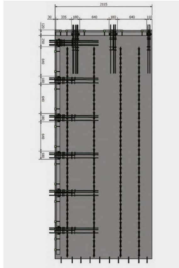
■ Rive et about de ThermoPrédalle® BA 0,45 munis de rupteur thermique.
