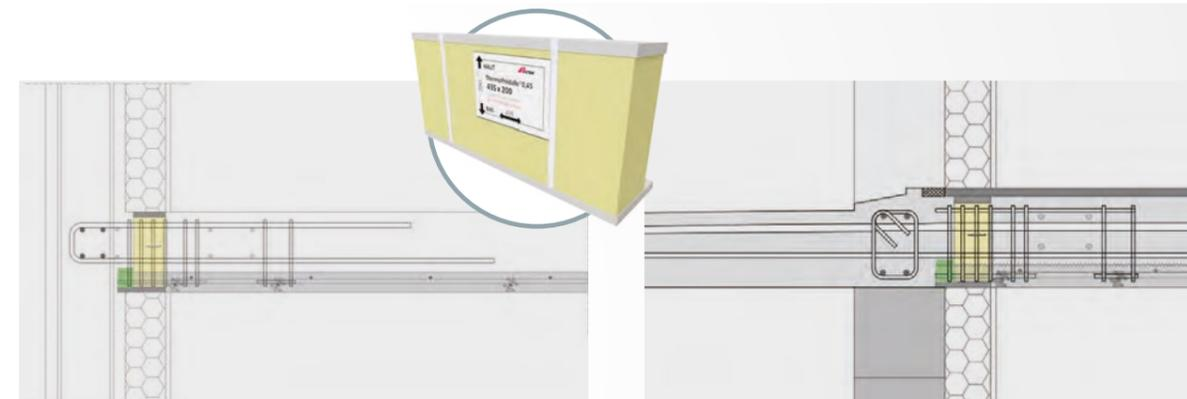
■ Coupe ThermoPrédalle® BA 0,45 en plancher intermédiaire au droit des paniers : les pains isolants sont placés dans la continuité de l'isolation intérieure.
