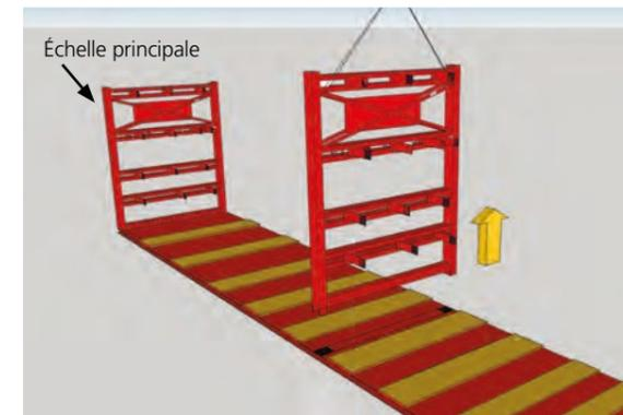
**Le levage s'effectue avec l'échelle principale** (celle opposée aux stabilisateurs) en place et uniquement avec cette échelle. (Mode de démontage page suivante)
