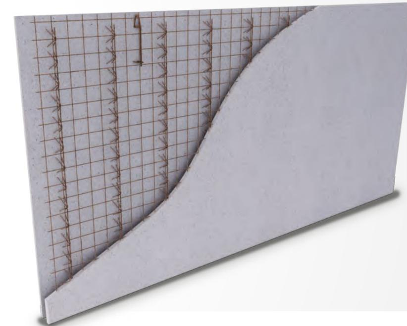
Élément de structure vertical préfabriqué en usine, le Prémur se compose de 2 parois de béton assemblées et reliées entre elles par des armatures spécifiques adaptées.
