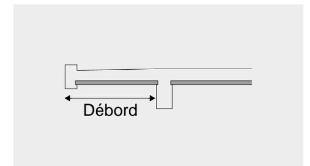
■ Les balcons en prolongement de plancher peuvent être réalisés à partir de Prédalles interrompues sur appui.
