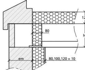
\*Conductivité thermique = 0,20 W/m.K Coupe voile maçonnerie avec planelle
