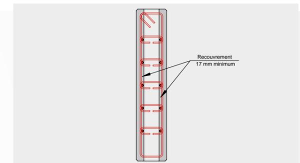
L'espacement des lits d'armatures est limité à 15 cm pour permettre un bon remplissage du noyau du Prémur.
