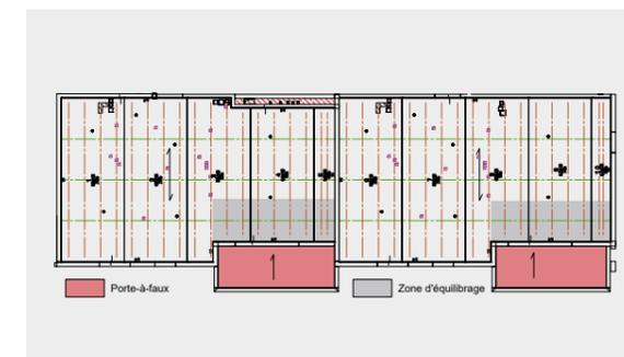
■ Zone d'équilibrage d'un plancher prolongé par un porte-à-faux (cas de balcon non porté).
