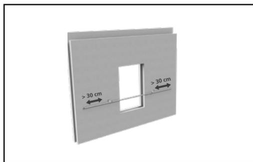
■ Installez les Tubes garde-corps dans les Platines brevetées en veillant à ce qu'il y est une garde minimale de 30 cm de chaque côté.
