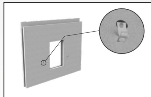
■ Fixez les Platines manuellement sur les douilles sans les serrer lors du déchargement à même le sol.
