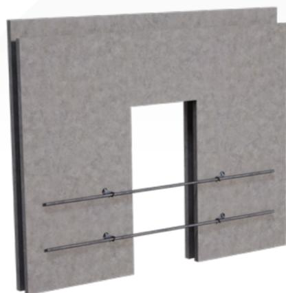
Rector propose **deux kits de fixation différents**, positionnés et intégrés dans les prémurs en usine. Les kits sont fabriqués en fonction de la hauteur de l'allège de l'ouverture à sécuriser :
