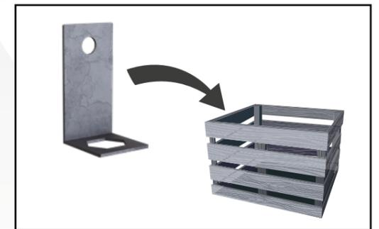
■ Réalisez les étapes 2 à 4 dans le sens inverse. Après avoir retiré les Platines, déposez les dans votre caisse à matériel pour une réutilisation ultérieure.
