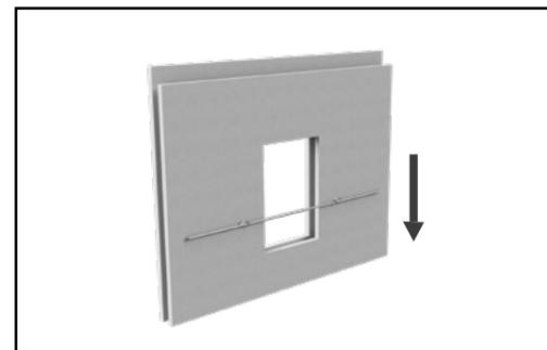
■ Maintenir les Tubes garde-corps vers le bas lors de l'application d'un couple de serrage de 10 N.m minimum.
