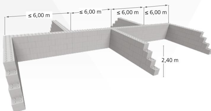
Jusqu'à 2,40 m de haut avec cloisons transversales stabilisantes
